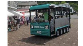
低速電動バス(eCOM-8) ・最高速度 19 km/h ・燃料: 電気 10人乗り
